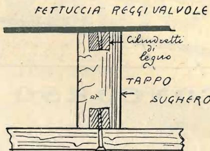
coltellino due nicchie, una per testa, capaci di contenere ciascuna un cilindretto di legno che si fisserà al sughero con colla da falegnami. Su questi cilindretti si fissa poi con viti la fettuccia reggivalvole contro il fondo. Grazie ai piedini di sughero, alla fettuccia reggivalvole è permessa una certa elasticità in ogni senso.
